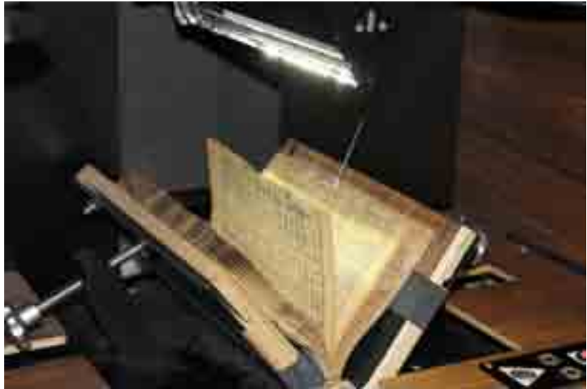
Scanroboter im Einsatz (Modell MDS 2.0)
