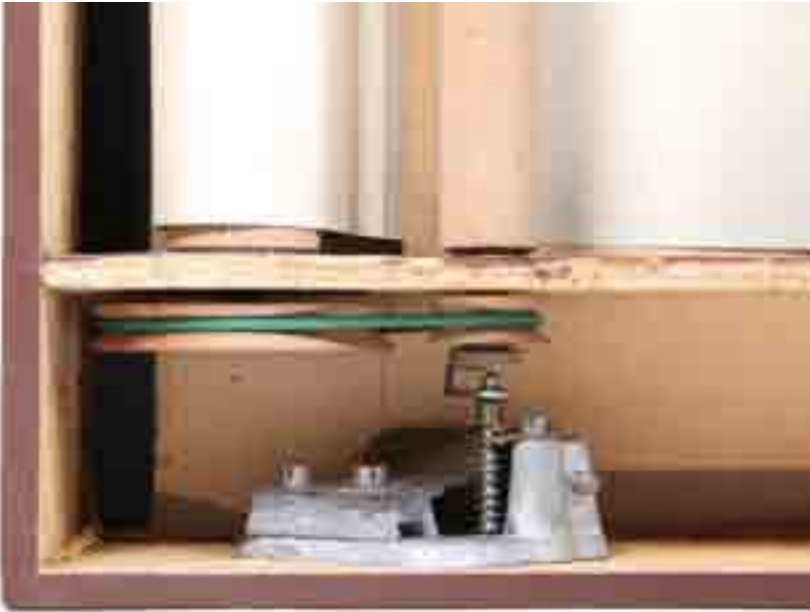
Riemenantrieb auf Holzscheiben mit neuem Antriebsriemen (grün)
