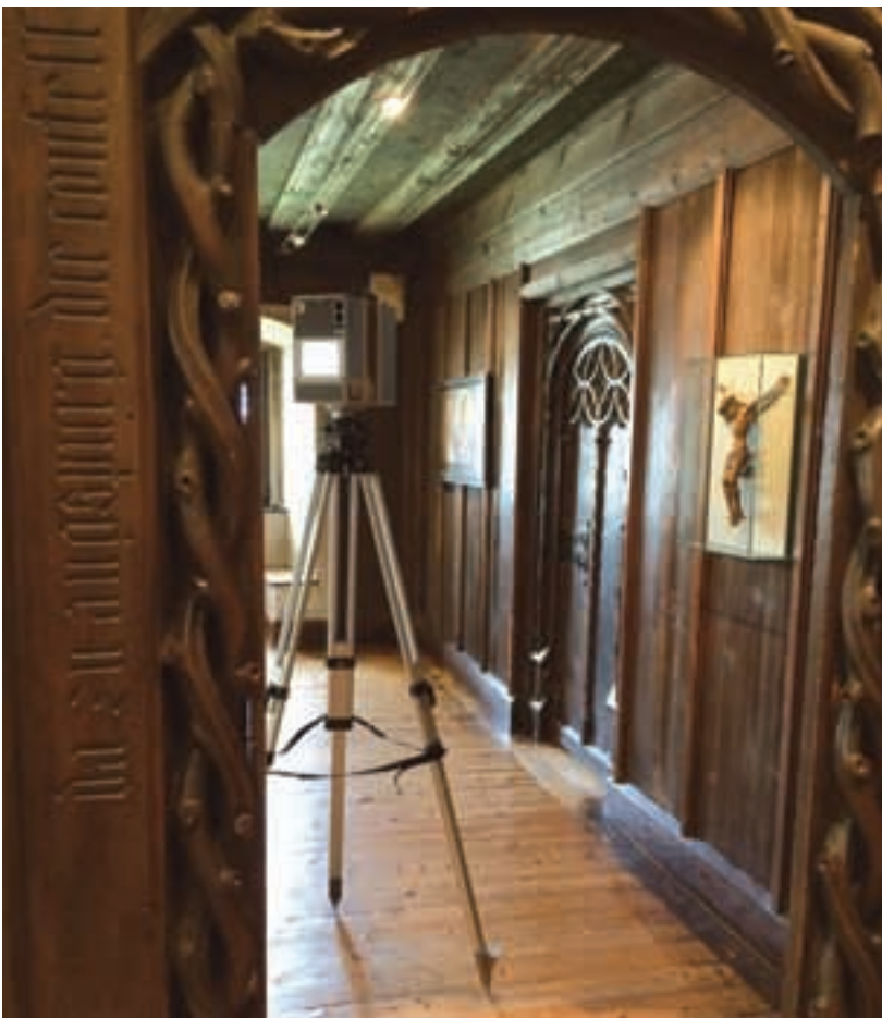
Abb. 2 Laserscanner im Einsatz bei der Vermessung der Lutherstube auf der Veste Coburg.
