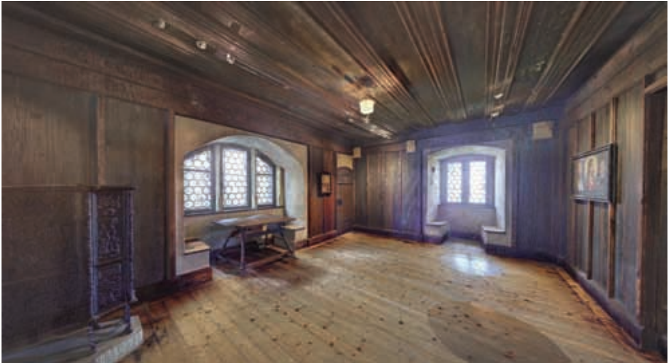
Abb. 10 Lutherstube auf der Veste Coburg. Gerenderte farbige Punktwolke bestehend aus mehreren Einzelscans.
