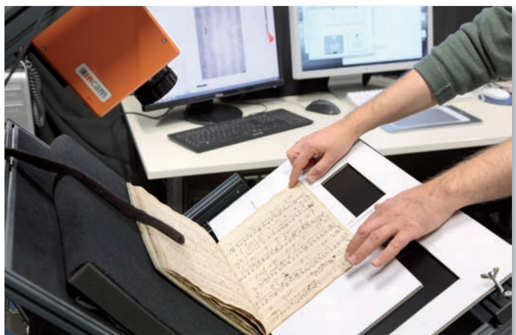
Abb. 3: Thermographiesystem: Thermographiekamera und Grazer Buchtisch
