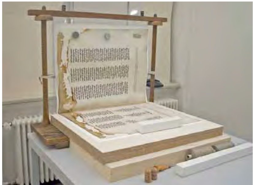
Spezialkonstruktion auf der Heftlade zum Verbinden der einzelnen Lagen
