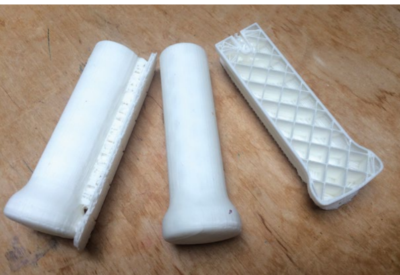
Verschiedene Varianten des 3D-Drucks; links: mit Sockel und Stützstrukturen, Mitte: ohne Sockel und Stützstrukturen, rechts: im Querschnitt
