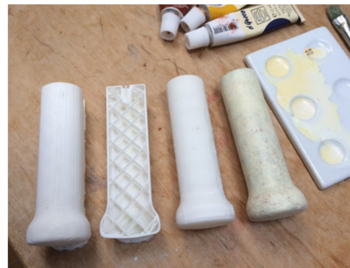
Ergänzung aus dem 3D-Drucker, mit Acrylfarben bemalt
