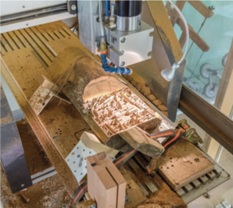
*Der mit den 3D-Daten gefütterte Computer steuert das Schneidewerk der CNC-Fräse auf Millimeterbruchteile genau.*
